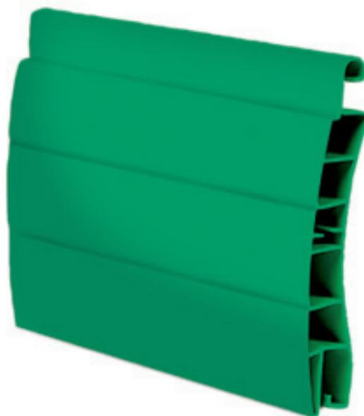
L'avvolgibile in pvc Serena (peso specifico standard di circa kg. 4,500/mq) è realizzato con stecche auto-aggancianti (a doppia parete e con intersezioni di irrigidimento interni) che misurano 13 mm di base e 55 mm di altezza. Il profilo è dotato di un fermo laterale "antisfilamento" che serve a bloccare le
